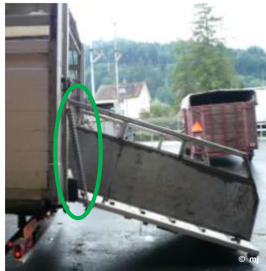
Korrektter Übergang zwischen Fahrzeug und Rampenseitenschutz
