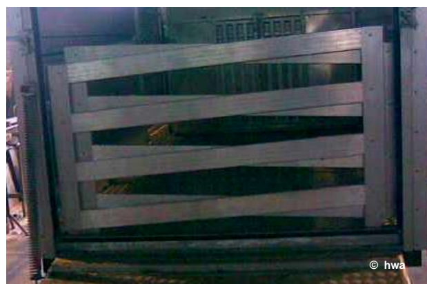
Abschlussgatter als zusammengeklappter Rampenseitenschutz.
