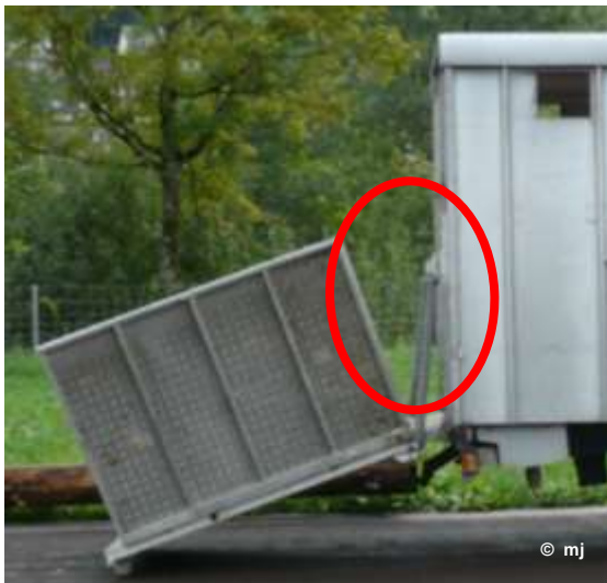
Nicht zulässiger Abstand zwischen Fahrzeug und Rampenseitenschutz
